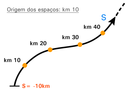
Figura 3.10: Coordenada espaço e marcos de quilômetros.
