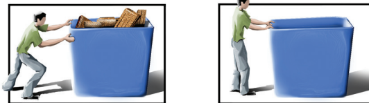
Caixa pesada (com muita madeira) Mais difícil de ser deslizada Caixa mais leve (com pouca madeira) Mais fácil de ser deslizada
