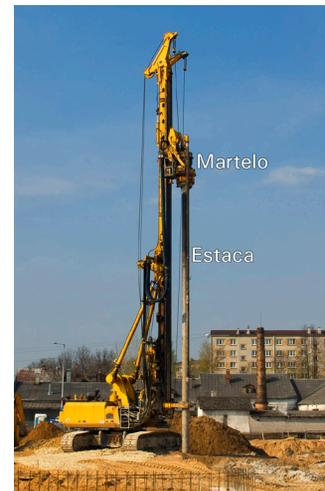
Figura 14.6: Um bate estaca converte energia potencial em energia cinética e essa pode ser facilmente utilizada. / Fonte: Adaptado de Thinkstock
