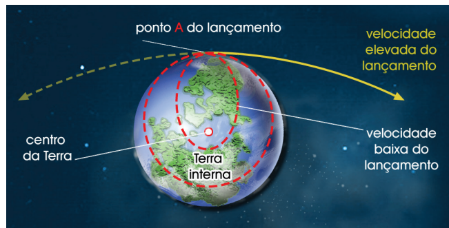
Figura 16.6: Quando a energia mecânica for positiva, a trajetória será um ramo de hipérbole.
