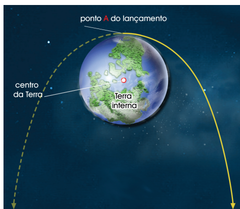
Figura 16.7: Trajetória parabólica ocorre quando a energia mecânica é nula.
