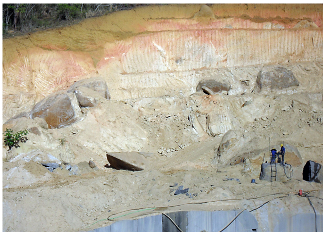
Figura 7.3: Fraturas de alívio em perfil exposto em pedra de granito, no Espírito Santo. No perfil, percebe-se pela mudança de coloração, o solo superficial, de cor castanha, o horizonte B, avermelhado, e o horizonte C, acizentado ou esbranquiçado. O núcleo do morro é constituído por granito inalterado, cujos blocos cortados pela lava de rocha ornamental podem ser vistos na parte inferior. Os blocos arredondados na parte intermediária a superiores são restos de granito que foram preservados no perfil, por serem um pouco menos permeáveis do que as partes ao redor. No entanto, seriam também intemperizados com o tempo, não fosse a interrupção do processo natural pelos trabalhos da mineração;
