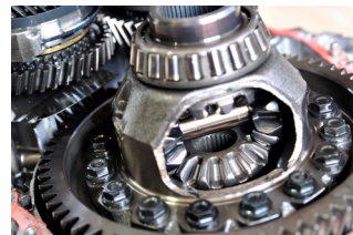
Figura 17.40: Engrenagem cônica. Diferencial de carros.
