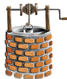
Figura 17.38: Sarilho usado para erguer balde com água do interior de uma cisterna com água.
