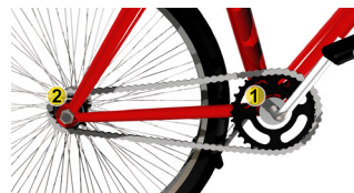
Figura 17.41: Sistema de engrenagem em uma bicicleta de marcha única. A engrenagem de acionamento é denominada “coroa” e a acoplada à roda traseira é conhecida como “catraca”.
