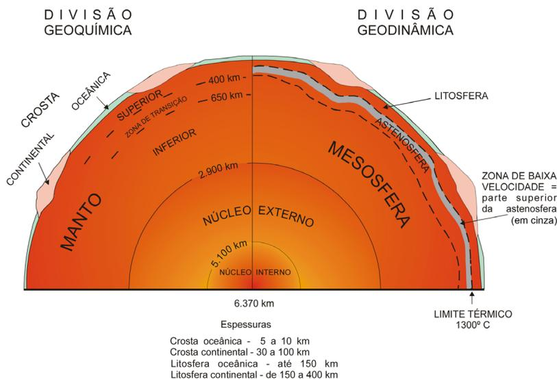
**Figura 3.7:** Divisão geoquímica (à esquerda) e divisão geodinâmica (à direita) da Terra. A crosta está representada nas duas partes, de modo a evidenciar que é parte da litosfera, camada mais externa na divisão geodinâmica; complementam as informações da figura alguns dados sobre espessuras, estado físico e temperaturas.
