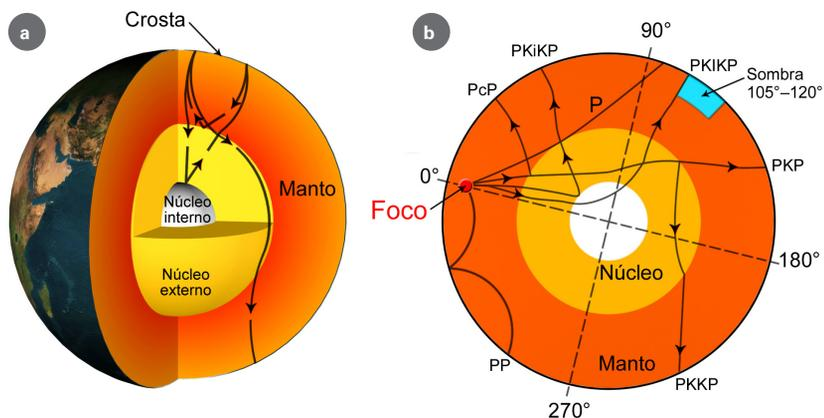
**Figura 3.5:** Estrutura interna da Terra (a) definida pela trajetória e velocidade das ondas sísmicas e exemplos de trajetórias de ondas (b), que são refletidas ou desviadas com as mudanças do meio de percurso; o percurso da onda P no núcleo externo (líquido) é denominado K e no núcleo interno (sólido) é denominado I; assim, a indicação PKP significa tratar-se de uma onda P que atravessou o manto, depois o núcleo externo (indicado pela letra K), e voltou pelo manto como onda P.
