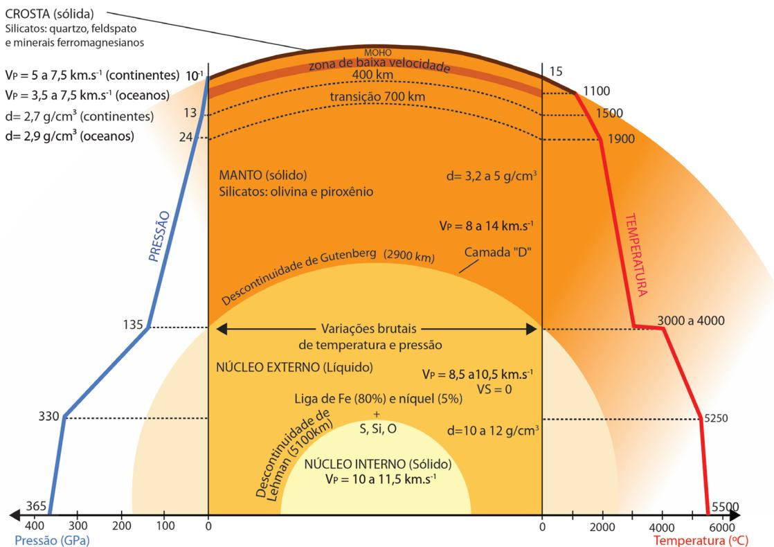
**Figura 3.12:** Esquema do interior da Terra mostrando o zoneamento químico e sísmico, resultado da diferenciação geoquímica, em associação com informações de composição mineral e química e variação dos parâmetros temperatura e pressão. Vp= velocidade de ondas P; d= densidade.
